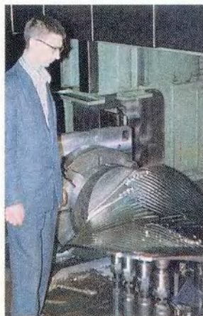
Это не винт для подводной лодки, а лопасть насоса, спроектированная в системе ГЕМОС и отфрезерованная на Уралгидромаше
